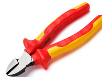
REF 2000 1650002 ZIJKNIPTANG VDE 160MM • Bi-materiaal handvat • Chroom-vanadiumstaal • Snijlengte 22mm • Snijcapaciteit half harde draad : Ø 1.6mm • VDE 1000V DIN EN/IEC 60900
