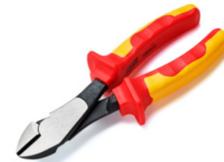
REF 2000 1650003 KRACHT-ZIJKNIPTANG VDE 180MM • Bi-materiaal handvat • Chroom-vanadiumstaal • Snijlengte 25mm • Snijcapaciteit harde draad : Ø 1.8mm • VDE 1000V DIN EN/IEC 60900
