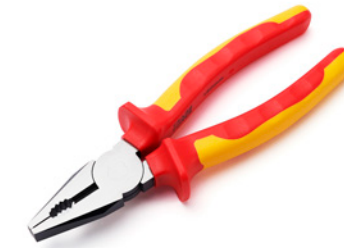
REF 2000 8360004 COMBINATIETANG VDE 180MM • Chroom-vanadiumstaal, gesmeed en gehard • Knijpt glad • Goede grip voor plat en rond materiaal • VDE 1000V DIN EN/IEC 60900
