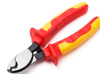
REF 2000 1600003 KABELNIPTANG VDE 160MM • Geschikt voor CU & AL- kabel, één- en meerdrads • Snijcapaciteit koperdraad : 22mm 2 • Niet geschikt voor staal- en hardgetrokken koperdraad • Knijpt glad zonder vervorming • Handige éénhandsbediening • VDE 1000V DIN EN/IEC 60900
