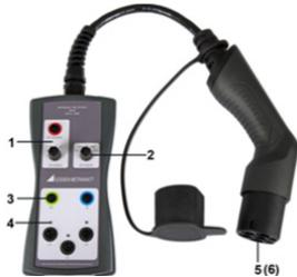
Permet un contrôle du fonctionnement dans le champ de la station de charge et du câble de charge.
