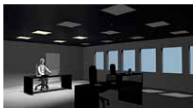
Bureau individuel ou éclairage en fonction de la présence (Esylux)
