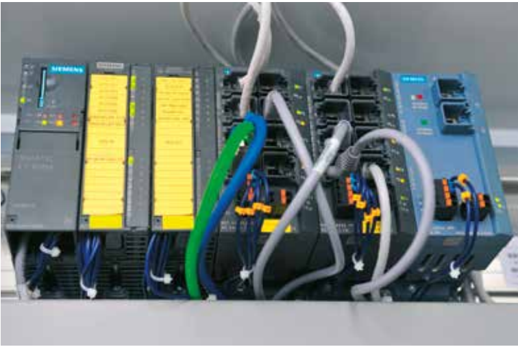
Tous les systèmes de caméras et les capteurs sont connectés aux mêmes switches que les contrôleurs programmables.
